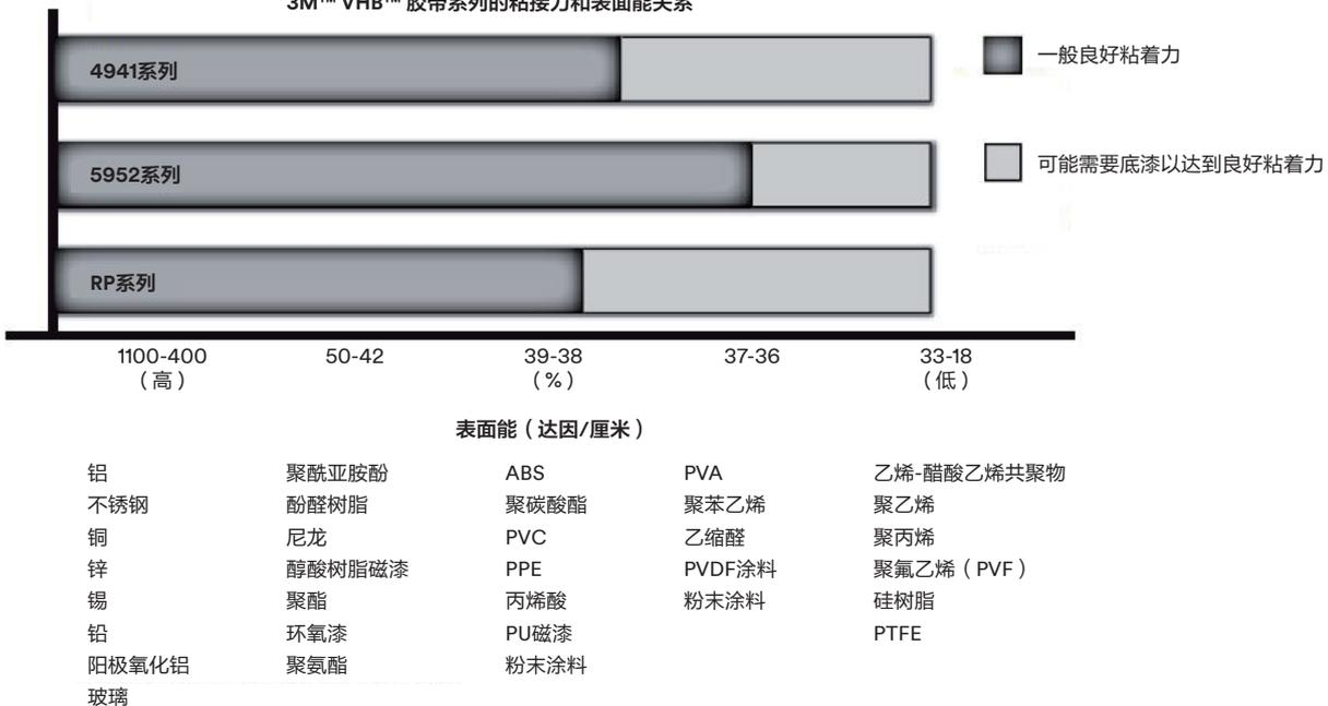
注意：基材拥有各种配方、表面加工和表面处理，可对粘结强度造成影响。此图表的目的在于以铝基材表面的粘结强度水平为参考，提供常见材料上的预期粘接强度的粗略估计。泡棉类型可影响和/或限制最大粘结强度。
